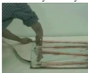
Υλικά και τρόπος / οδηγίες κατασκευής ενός προτύπου ηλιακού θερμοσίφωνα
