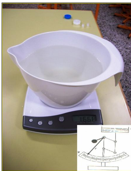
Εικόνα 4: Ιδιοκατασκευή εξατμισίμετρου τύπου Wild (στο κάτω δεξιό μέρος φαίνεται σχηματικά η αρχή λειτουργίας του)
