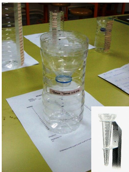
Εικόνα 3: Ιδιοκατασκευή βροχομέτρου από δοχείο εμφιαλωμένου νερού (στο κάτω δεξιό μέρος φαίνεται εικόνα πραγματικού βροχομέτρου προσαρμοσμένου σε ξύλινο στήριγμα)
