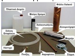
Υλικά και τρόπος / οδηγίες κατασκευής ενός προτύπου ηλιακού θερμοσίφωνα
