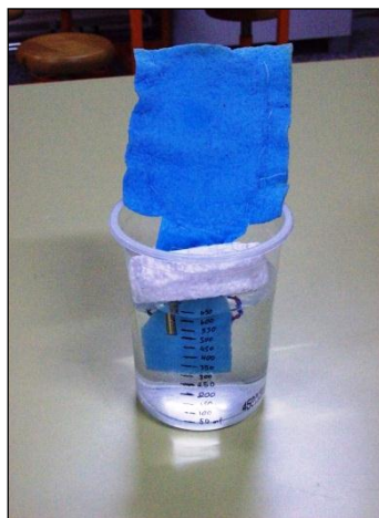
Εικόνα 7: Καινοτομική Ιδιοκατασκευή εξατμισίμετρου
